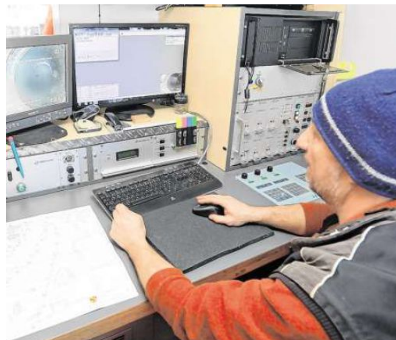
Bernd Günther öffnet den Kanaldeckel und überprüft mit seinem Kollegen Emanuel Pane von der Firma Dorr das Kaufbeurer Kanalnetz in der Apfeltranger Straße. Dazu lassen sie eine Kamerasonde in die Tiefe hinunter. Im Transporter verfolgt Günther die Kamerafahrt im Untergrund am Bildschirm.
